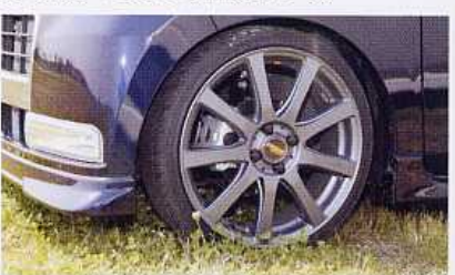
17インチのホイールは、エーテックのファイナルスピード・フェイバー9。タイヤはヨコハマS-Driveの165/40-17。
