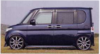
車高はRS-Rのベーシック・アイ車高調でローダウン。ちゃんと走行できて、見た目にもOKな車高にセットしてある。
