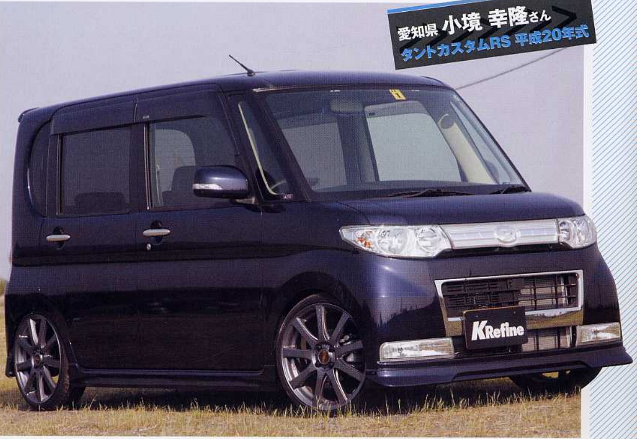
車高はRS-Rのベーシック・アイ車高調でローダウン。ちゃんと走行できて、見た目にもOKな車高にセットしてある。
