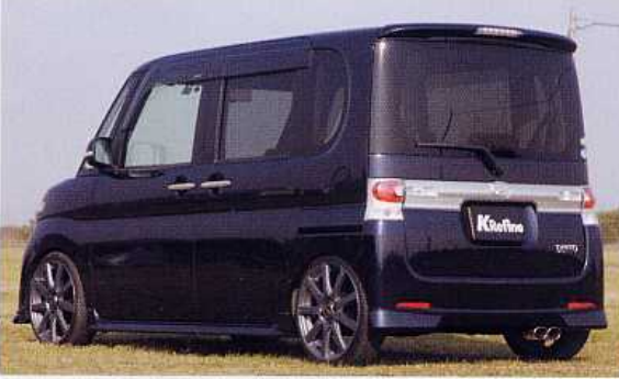
ローフォルムは発売されたばかりのRS-Rの車高調によるもの。リアボトムには純正オプションのガーニッシュを装着。
